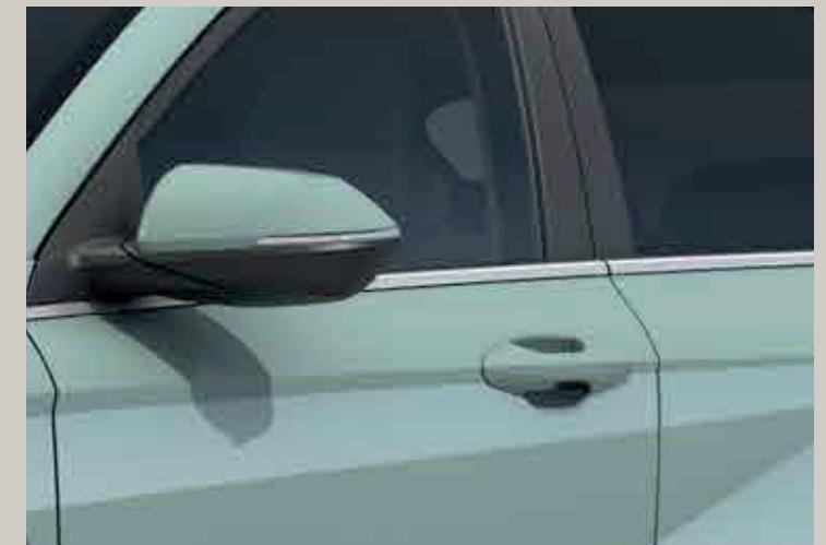
S vanjskih ručki na vratima uklonjeni su mehanički gumbi i primjenjeni su senzori za dodir u cilju ostvarenja visokotehnološkog senzibiliteta i praktičnosti.
