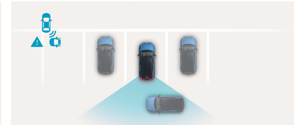
Prilikom kretanja vozila unazad, sustav pomoći pri izbjegavanju sudara (PCA) upozorava vozača ako se vozila približavaju sa strane i također automatski primjenjuje kočnice. ◊
