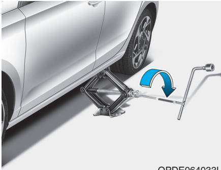
8. Umetnute ručicu u dizalicu i okrenite ju u smjeru kazaljke na satu, podižući vozilo dok se guma ne podigne s tla. To je otprilike 30 mm. Prije uklanjanja matica s kotača, vodite računa da je vozilo stabilno i da nema šanse za pomicanje ili klizanje.
