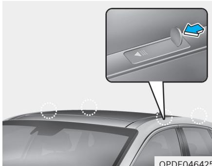
Za ugradnju ili uklanjanje krovnog nosača, možete koristiti montažni podupirač i poklopac na krovu.
