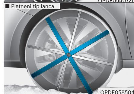
S obzirom na to da su bočne stijenke radikalnih guma tanje od drugih vrsta guma, gume mogu biti oštećene montažom nekih vrsta lanaca za snijeg na njih. Stoga, preporučuje se uporaba zimskih guma umjesto lanaca za snijeg.
