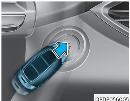
Ako je baterija smart ključa slaba ili smart ključ ne radi ispravno, možete pokrenuti motor pritiskom na Start/Stop tipku motora s pomoću smart ključa kako prikazuje ilustracija.
