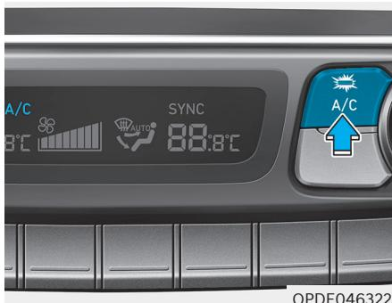
Pritisnite prekidač A/C za uključivanje sustava klimatizacije (svjetlo indikatora će svijetliti).
