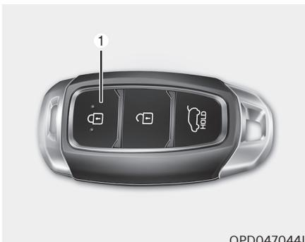
Pomicanje prozora možete nadzirati i kad je motor isključen pritiskom na prekidač za zaključavanje (1) duljim od 3 sekunde. Prozori se zatvaraju (pomiču prema gore) dok držite prekidač pritisnut. Pomicanje prozora se zaustavlja kad pustite prekidač. Svi žmigavci blicnu tri puta kad se prozor zatvorí do kraja.
