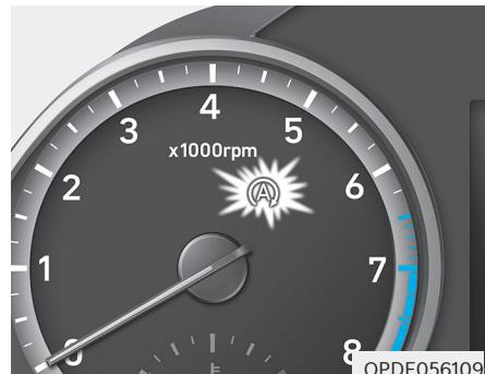
Zaustavljanje motora u ISG modu (osim 48V MHEV)
