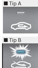
S odabranim položajem vanjskog (svježeg) zraka, zrak ulazi u vozilo izvana i tada je grijan ili hlađen prema odabranoj funkciji.
