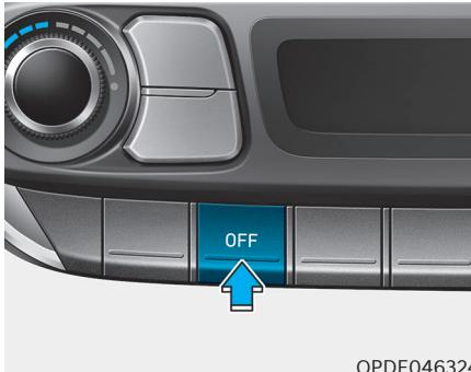
Pritisnite prekidač OFF za isključivanje sustava klima-uređaja. Međutim, još uvi-jek možete upravljati prekidačima za ulaz zraka dok god je prekidač za paljenje u položaju ON.
