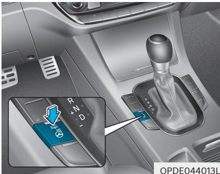
S prekidačem za paljenje u položaju ON, pritiskanje prekidača grijanja upravljača grije upravljač. Indikator na prekidaču će zasvijetliti i obavijestiti Vas na LCD zaslonu.
