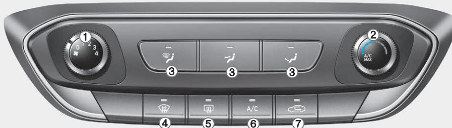
1. Prekidač za kontrolu brzine ventilatora
