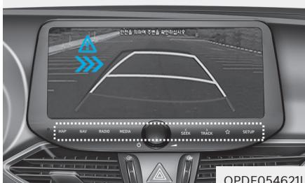
Rear Cross-Traffic Safety sustav će upozoriti vozača da prijeti sudar u ovisnosti o riziku: 'Collision Warning' (prijeti sudar), 'Emergency Braking' (kočenje u nuždi) i 'Stopping vehicle and ending brake control' (zaustavljanje vozila i kraj nadzora nad kočnicama).
