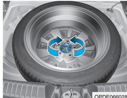
Okrenite vijak krilatog držača suprotno od kazaljke na satu.
