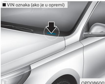
VIN je također na pločici pričvršćenoj na vrhu armature. Broj na pločici lako je vidljiv izvana kroz vjetrobransko staklo.
