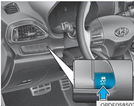
Električka kontrola stabilnosti (ESC) je sustav koji pomaže stabilizirati vozilo u zavojima.
