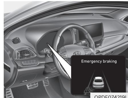
Kako bi vozača upozorio na opasnost od sudara, poruka upozorenja se prikazuje na LCD zaslonu praćena treptanjem indikatora na retrovizoru, zvučnim upozorenjem i podrhtavanjem upravljača (ako je taj sustav u opremi).
