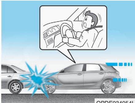
U nekim sudarima male brzine zračni jastuci se možda ne napušu. Zračni jastuci su osmišljeni da se ne napušu u takvim slučajevima jer oni ne mogu pružiti dodatnu zaštitu pored sigurnosnih pojaseva u takvim sudarima.
