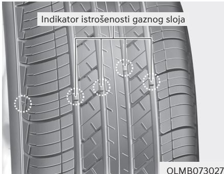
Ako je guma jednako istrošena, pojavit će se indikator istrošenosti gaznog sloja u obliku čvrste trake u gaznom sloju. To pokazuje da je preostalo manje od 1,6 mm gaznog sloja gume. Zamijenite gumu kad se ovo dogodi.
