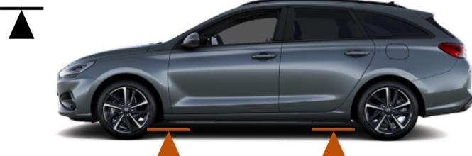
Za stabilizaciju vozila poduprite na četiri točke, direktno ispod prednjih i stražnjih stupova, pomoću drvenih blokova ili jednakovrijednih predmeta
