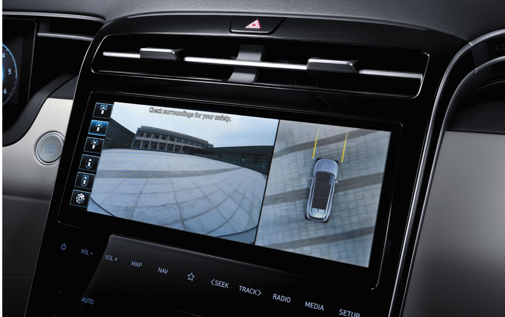
Surround View Monitor (SVM) Uživate u vidljivosti od 360° za lakše i sigurnije parkiranje. Četiri kamere visoke razlučivosti postavljene na prednjoj, bočnoj i stražnjoj strani vozila prikazuju okolinu u stvarnom vremenu.
