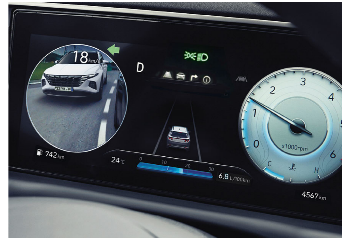
Nadzor mrtvog kuta (Blind Spot View Monitor - BVM) Učinite nezgodne promjene traka sigurnim i jednostavnim. Sada na zaslonu u digitalnom klasteru možete vidjeti stražnji lijevi i desni bočni prikaz. Kamere se aktiviraju upotrebom pokazivača smjera.
